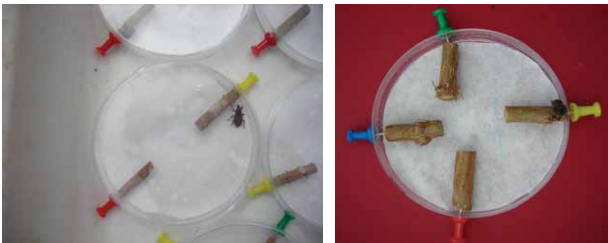
Figura 3.6: Dispositivos experimentales para el ensayo in vitro de preferencia (a) y de tasa de ingestión (b)
